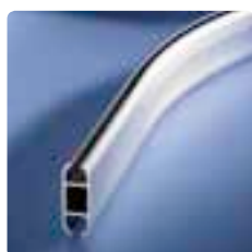
36.3445.31 Bogen 45° aus Schiene 2-Kanal FLACH Aluminium eloxiert R=250 mm mit gerade auslaufenden Enden Gesamtlänge=396 mm
